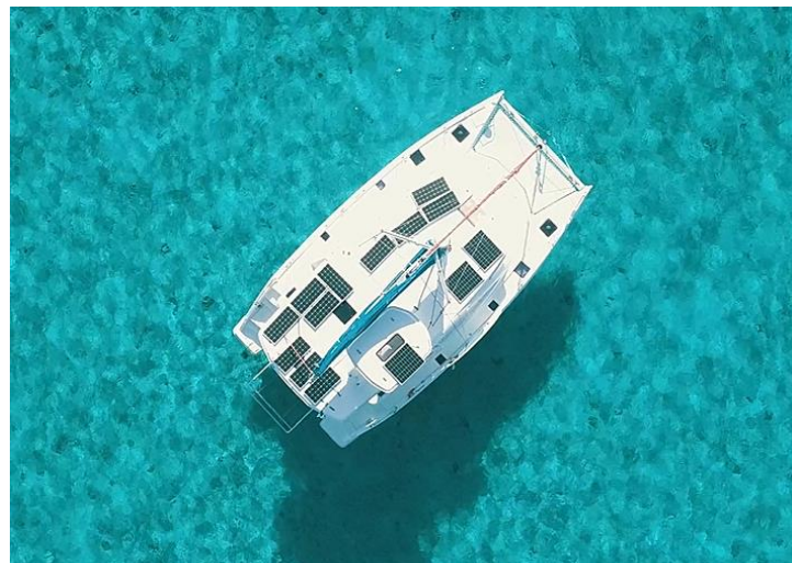
Foto oben: JONATHAN ist dank über 3 KW Solarpaneele am Dach und 2.100 A Litumbatterien unabhängig von fossilen Energieträgern.
