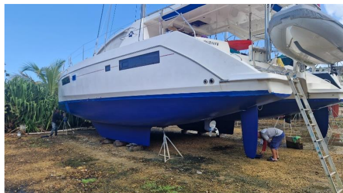
Foto links: Wir beeilten uns, damit alle Arbeiten rechtzeitig fertig werden. Hier Antifouling aufgetragen und neuer Propeller angebracht.
