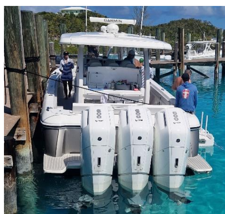
Foto links: 3 x Mercury Außenbordmotoren mit je 12 Zylinder und 600 PS.
