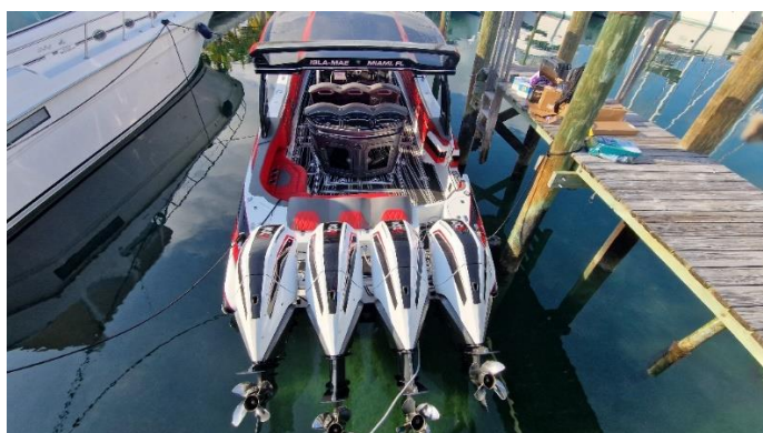
Foto links: 2000 PS am Heck dieses Motorbootes verbrauchen etwa 520 Liter/Stunde.
