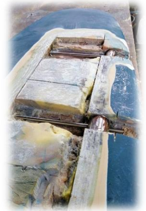
Foto rechts: Bei der Kontrolle auf der Werft entdeckten wir einen angehenden Schaden bei einem Ruderblatt. Wir bauten das Ruder aus und ließen es vorsorglich reparieren, um während der Segelzeit keinen Defekt zu provozieren.
