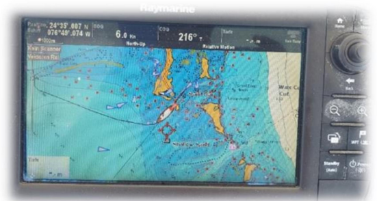
Foto oben: Am Bildschirm sieht man Schiffe, die auch AIS eingebaut haben.
