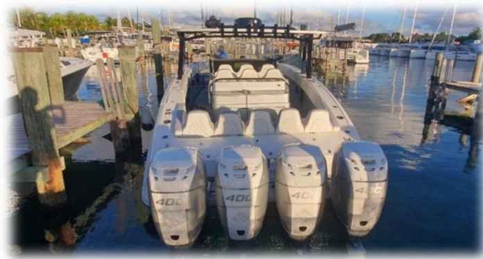
Foto oben: Das „Beiboot“ einer Superyacht, 32 Zylinder produzieren 1600 PS, Spritverbrauch: ca. 300 Liter/Stunde.
