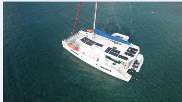
**Foto oben:** Solarstrom ist wesentlich für die autonome Zeit auf See. Hier 12 x 210 W Panele am Dach
