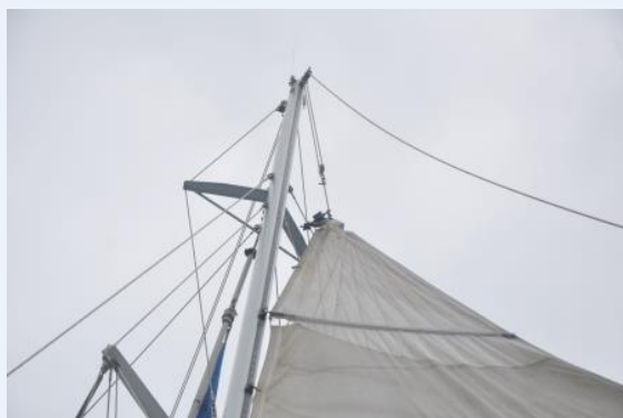
Bild links: Schlitten des Kopfbrettes löste sich auf
