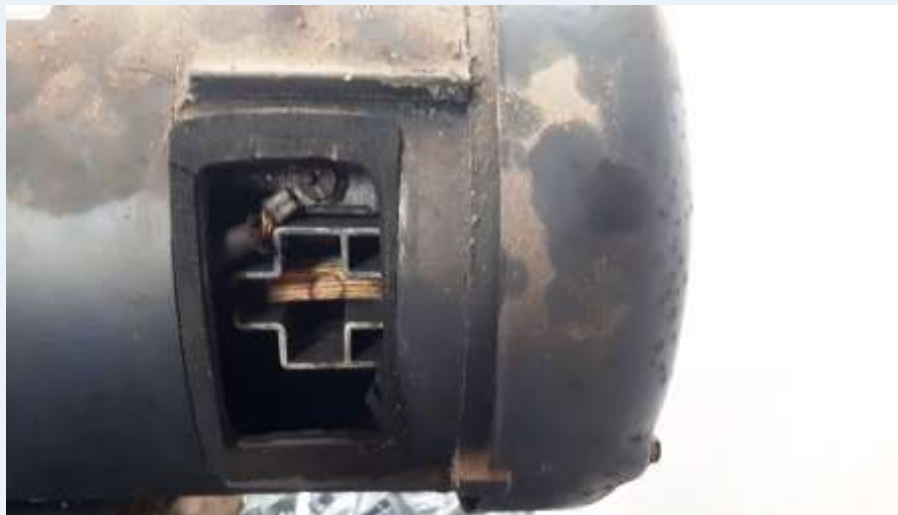
Foto oben: Holz anstatt neuer Kohlen montiert.
